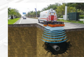
三维探地雷达检测道路下方空腔
