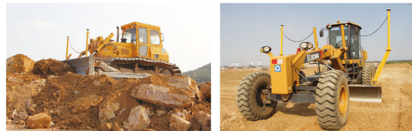
推土机、平地机智能施工系统 供图/合众思壮
